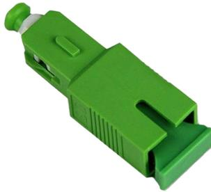
Il riflettore ottico genera una riflessione che permette a strumenti come l'OTDR il monitoraggio delle reti FTTH per di individuare un punto preciso nella tratta del cavo in fibra.
